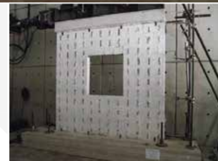
Sopra: Prova sismica su parete ISOTEX piena
