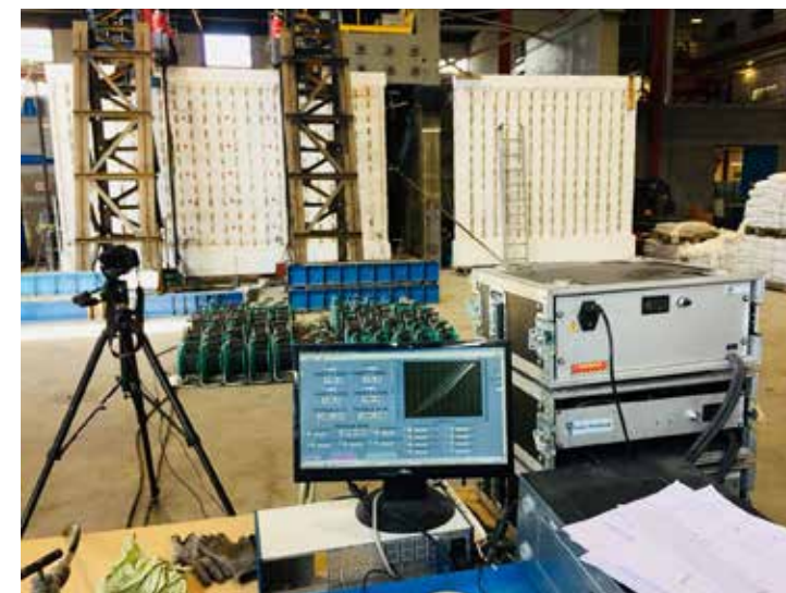
Ensayos experimentales realizados en Eucentre di Pavia para verificar el funcionamiento del sistema constructivo ISOTEX como viga de muro.
