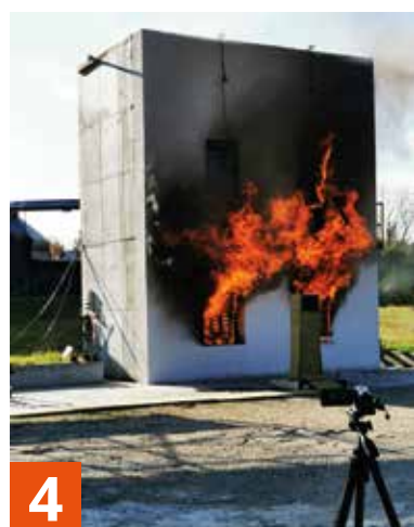
4 La prueba duró 60 minutos. Isotex superó la prueba de forma brillante.
