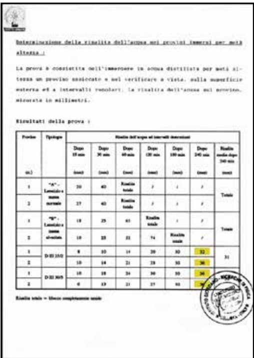
Prueba de ausencia de humedad ascendente
