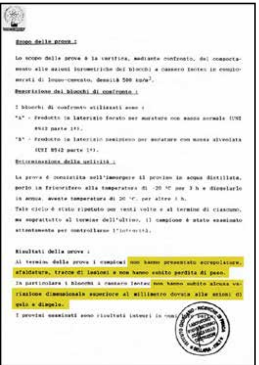
Prueba de heladicidad (hielo-deshielo) y estabilidad dimensional
