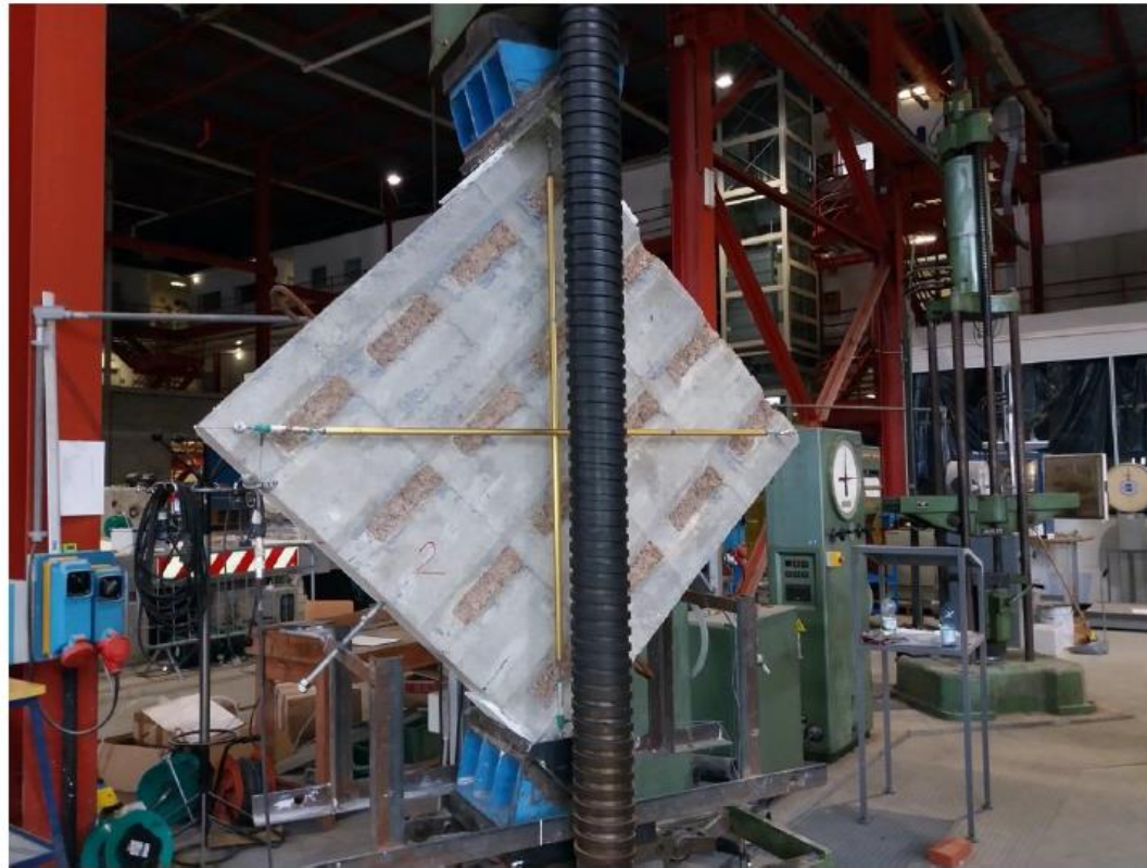
Figura 35: muro di dimensioni ridotte, layout prove di compressione diagonale
