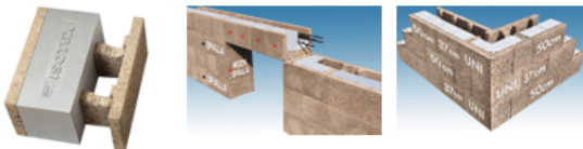
Figura 1 i blocchi sono realizzati con un conglomerato di legno mineralizzato e cemento, sono formati da due pareti longitudinali collegate da due setti trasversali che si sviluppano su una parte dell'altezza.
