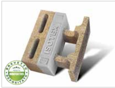
Blocco ventilato "Isotex Air" HDIII 44/11 con Neopor® BMBcert di BASF - U=0,19 W/m²K
