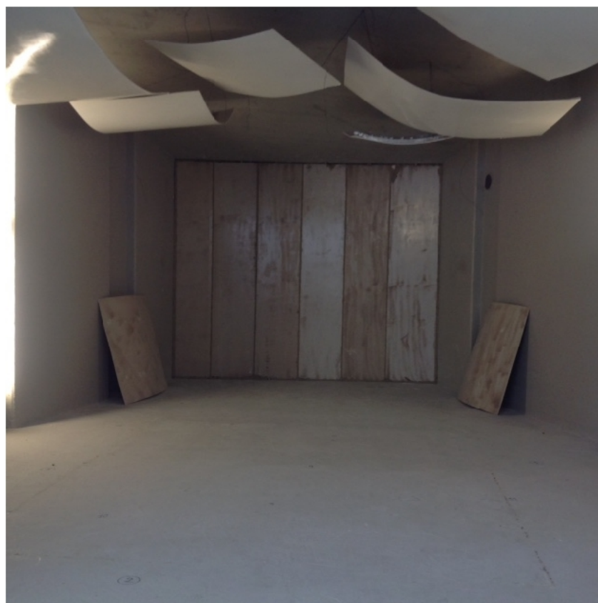
Figura 2. Camera riverberante in configurazione vuota
