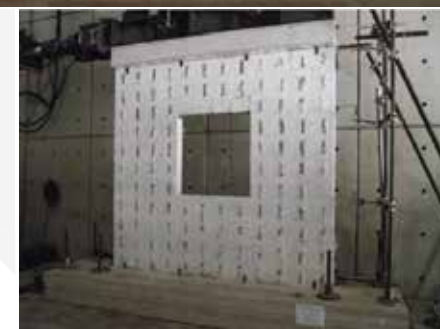
Sopra: Prova sismica su parete ISOTEX piena
