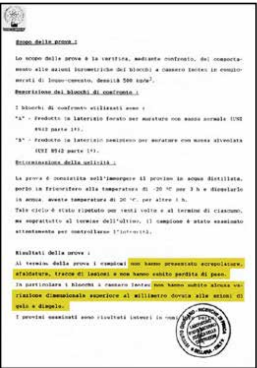
Prova di gelività (gelo e disgelo) e stabilità dimensionale
