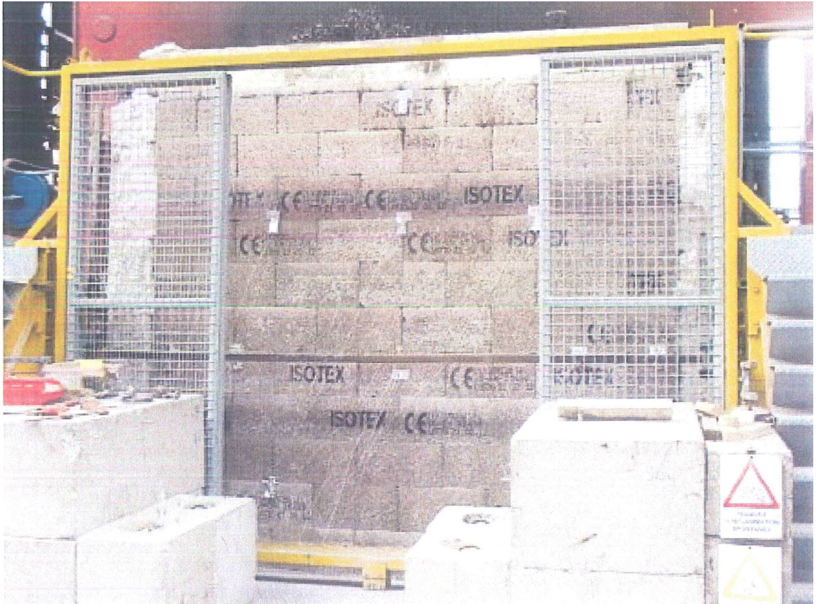
Vista d'insieme della faccia non esposta dopo raffreddamento
