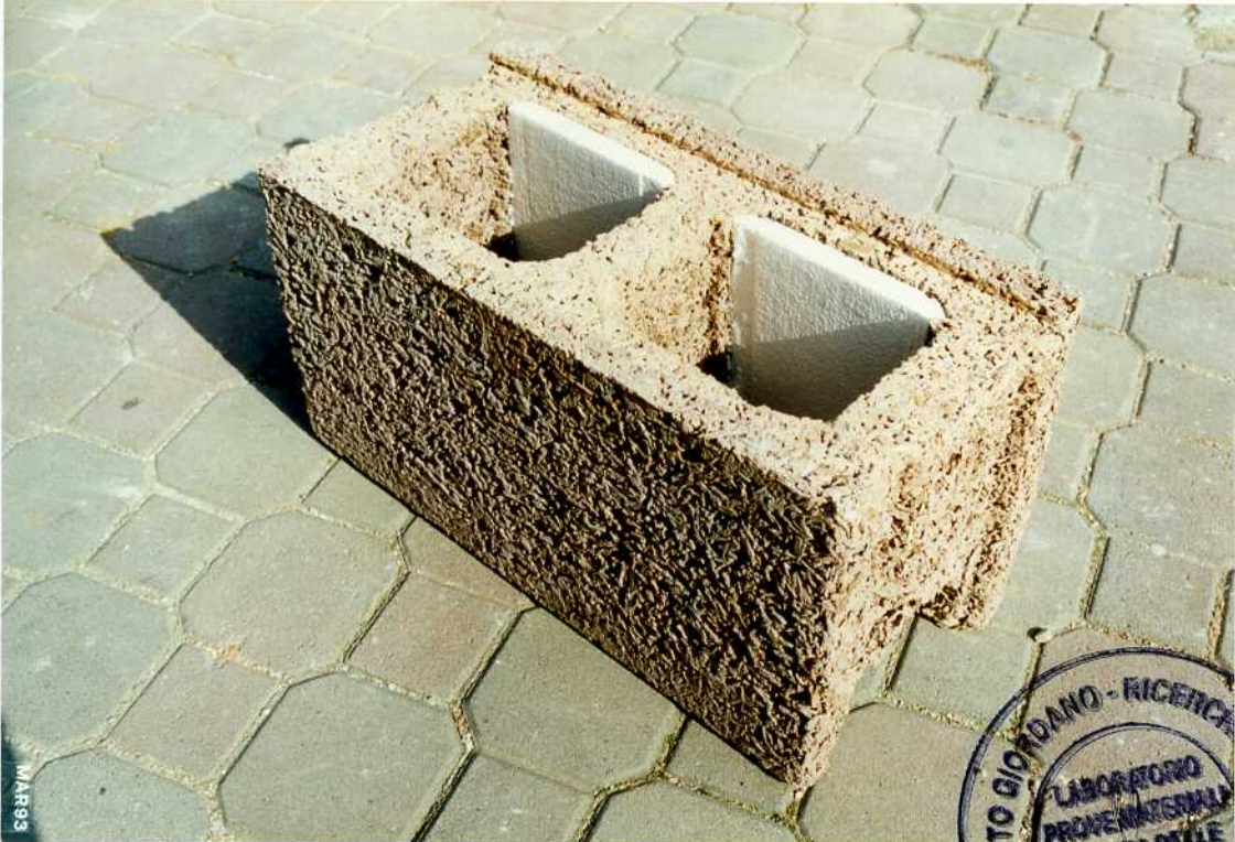
Fotografia del blocco a cassero Isotex "D III
