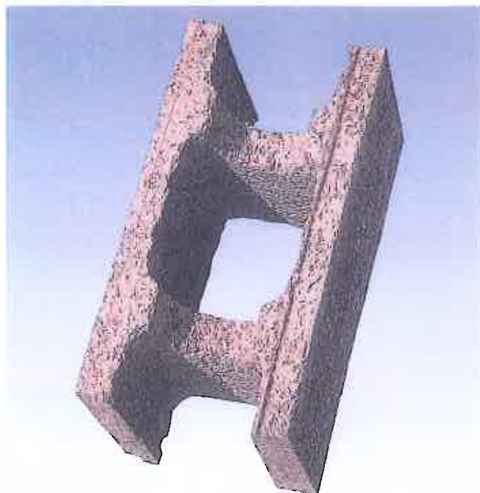
Blocco HB per pareti portanti interne, aumentando lo spessore del C.L.S., aumenta la capacità portante e l'isolamento acustico.
